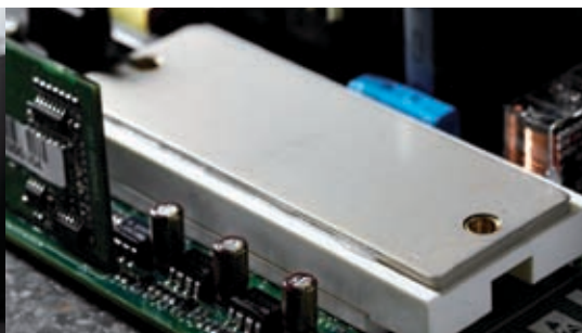
Control de calor integrado en IGBT
