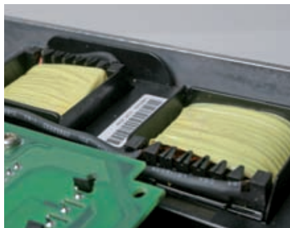
Bobinas CC reducen el ruido por armónicos y protegen a la unidad. También están integrados los filtros RFI (EMC) (cumpliendo EN 55011 A2,A1 o B).
